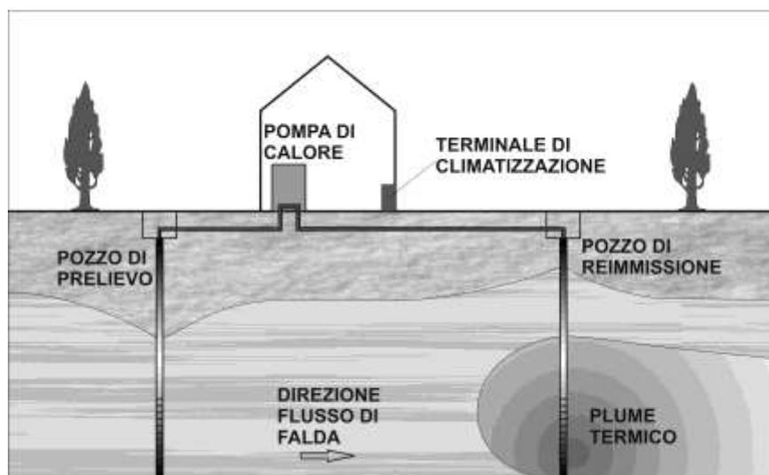
Fig. 13 – Schema di un impianto geotermico a circuito aperto: pozzo di prelievo, scambio termico con la pompa di calore, reiniezione in falda con sviluppo di plume termico a valle. Da: Casasso e Sethi, 2013 [10].
