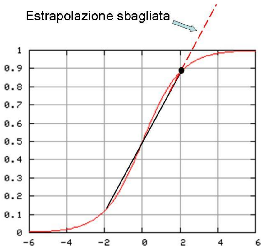
Fig. 4. Se ci si trova in corrispondenza del punto evidenziato in nero, utilizzare l'extrapolazione lineare della pendenza della curva che si ha alle spalle produce risultati completamente sbagliati.
