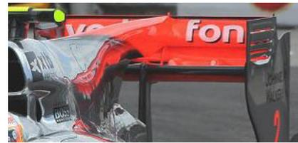
**Fig. 33** Particolare di F-Duct sulla McLaren MP4-25, Ref. [16]
