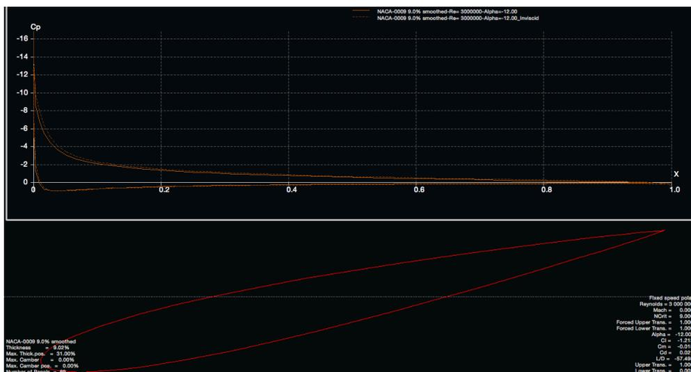
Fig. 2  $C_p$ -x di NACA 0009, caso inviscido (tratteggiato) e viscoso
