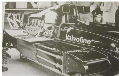
**Fig. 17** Lotus Tipo 78 con minigonne smontate, 1977, Ref. [1]
