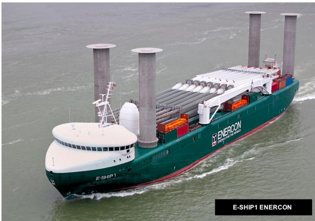
**Figura 37: Nave a rotore E-Ship 1 della Enercon.**
