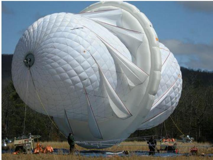
**Figura 34: MARS da 10 kW della Magenn Power Inc.**
