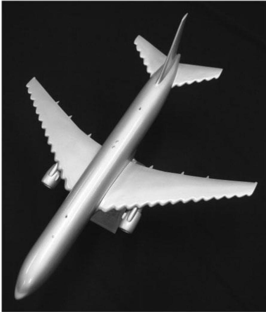
*Figura 36: Possibile applicazione dei tubercoli sul bordo d'attacco (1)*
