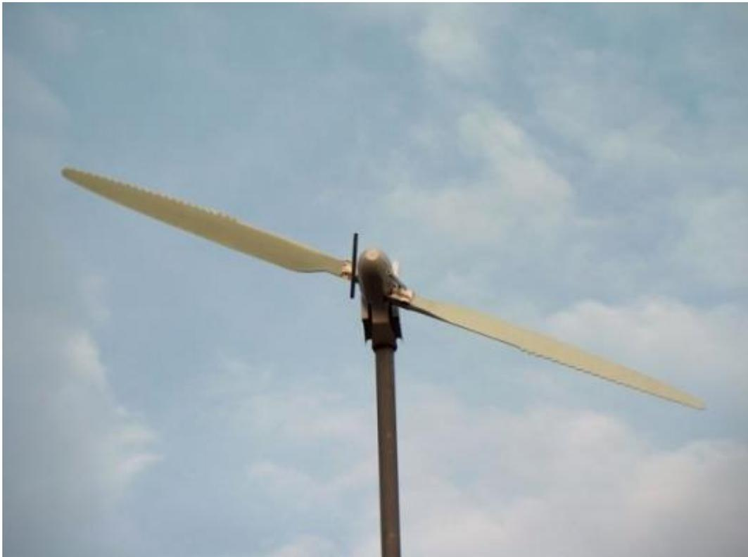
Figura 38: Prototipo di palette di turbina
