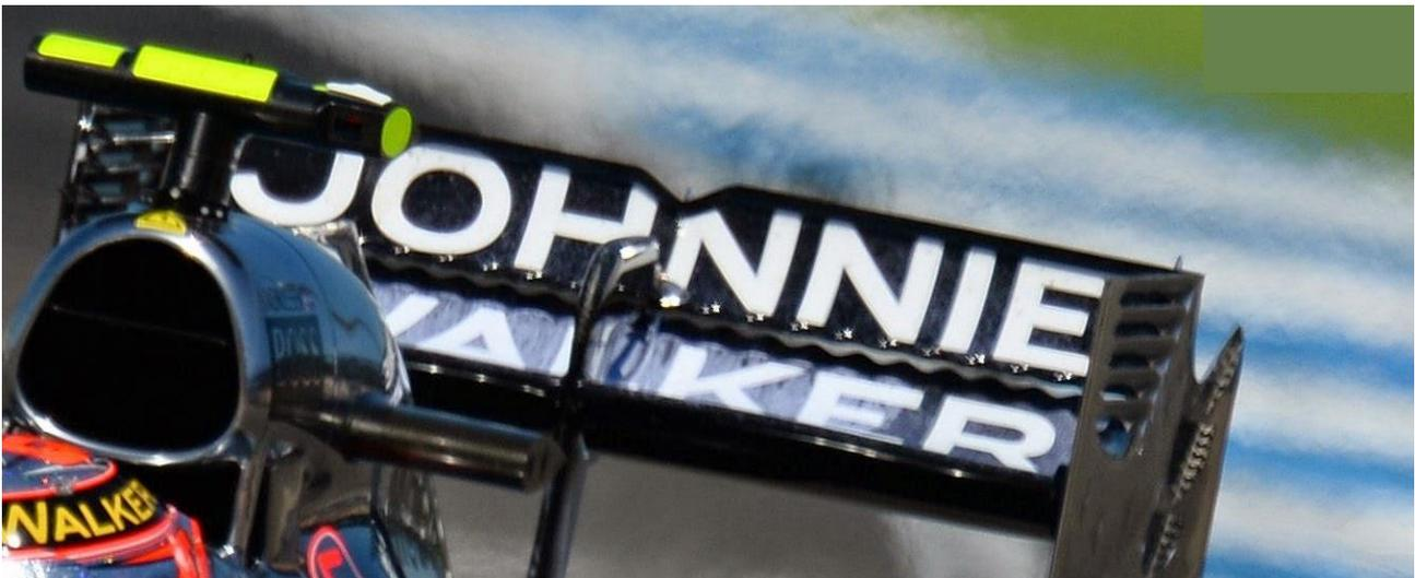
Figura 39: Tubercoli sul bordo di fuga dell'alettone principale della McLaren MP4-29
