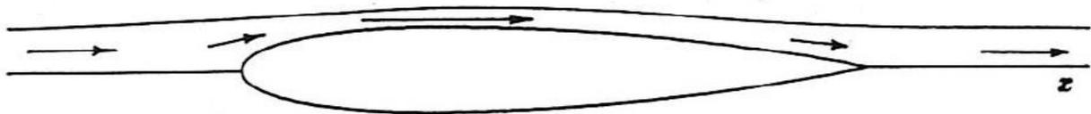
Figura 4 – Variazione della velocità attorno al profilo
