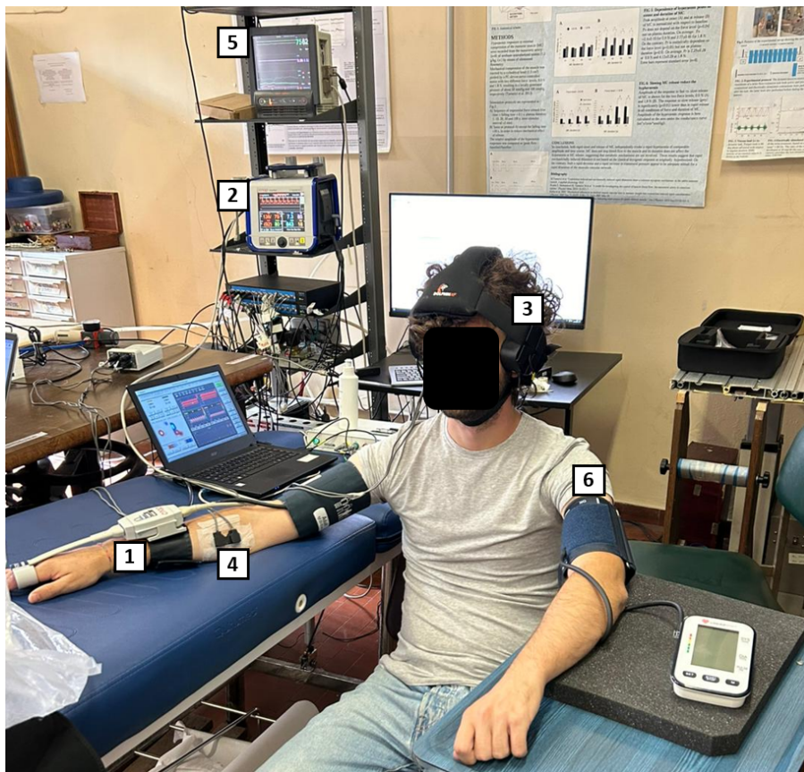
Figura 3.4: Soggetto in baseline con sensori posizionati (CNAP: 1-2, doppler: 3, NIRS: 4-5, sfigmomanometro: 6)
