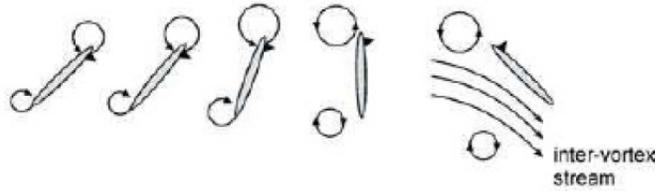
Figura 2.7: Schema del fenomeno del *wake capture*
